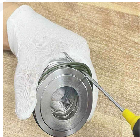
最后利用一字螺丝刀作为杠杆将油封撬进活塞的油封槽里面
