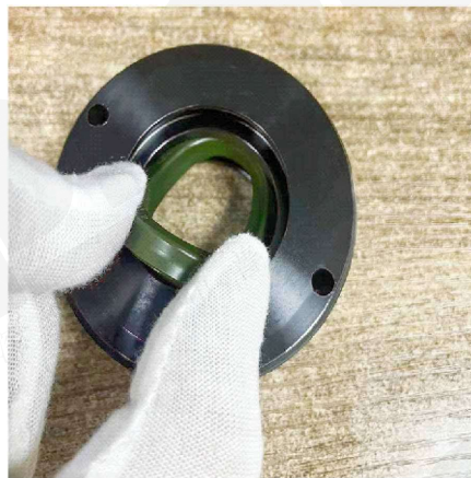
然后将油封的一部分放到对应的缸盖槽里面
