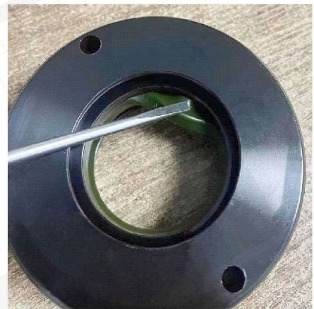
最后用光滑的一字螺丝刀将油封完全压塞到槽里面
