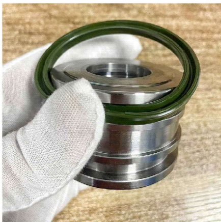
首先将油封用拇指固定一部分在活塞槽上
