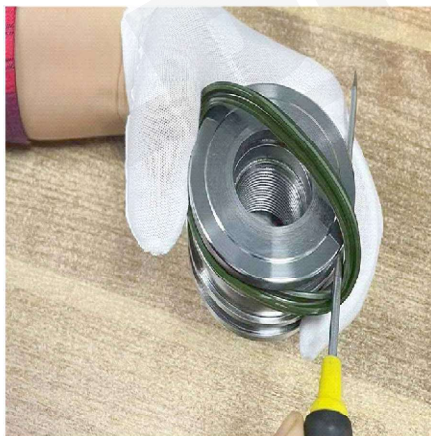
按住油封然后将一字螺丝刀穿过油封并且螺丝刀在槽里面
