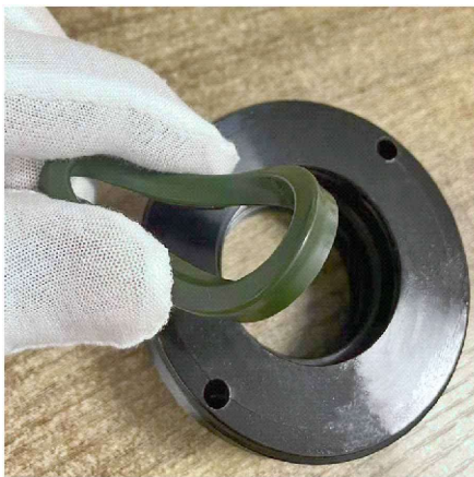
首先将油封弯成带角度的椭圆形
